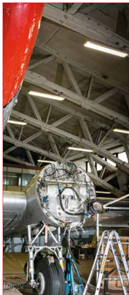
Bert Christensen i gang med at demontere dele fra den defekte motor, som efterfølgende skal monteres på den nye motor.
