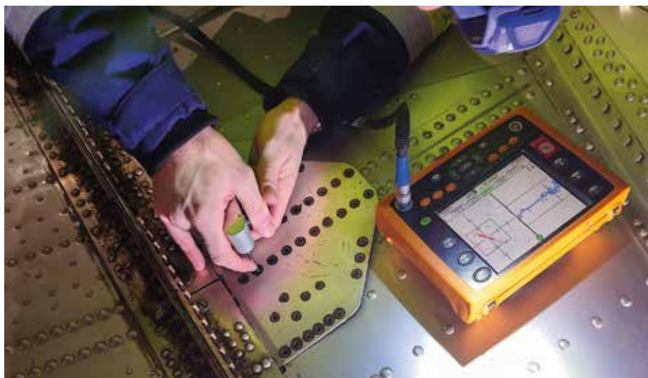
Højre vinge... naglehuller undersøges for korrosion
