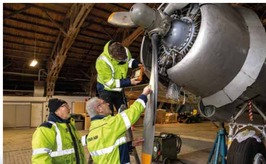
Propel, terminoverskridelse. Propellen undersøges for korrosion
