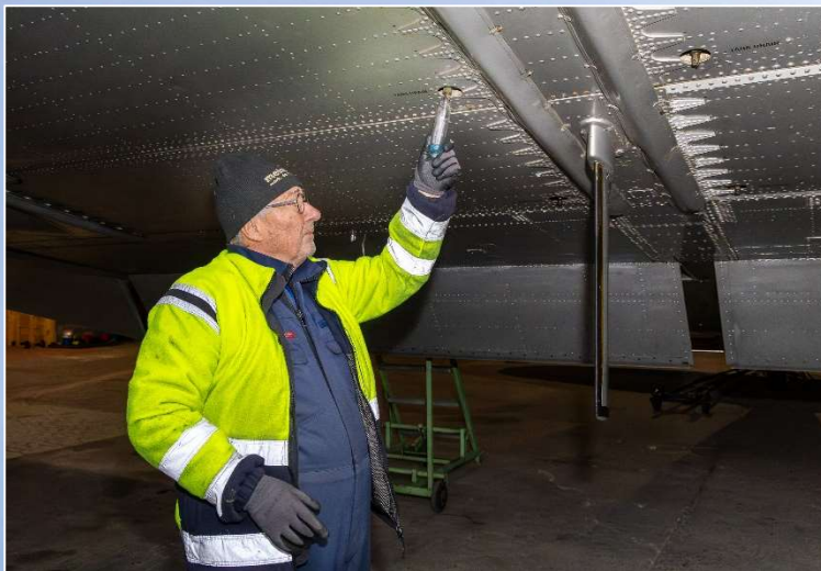
Brændstoftankene efterses og kontrolleres for kondensvand. Her er kun rent brændstof.
