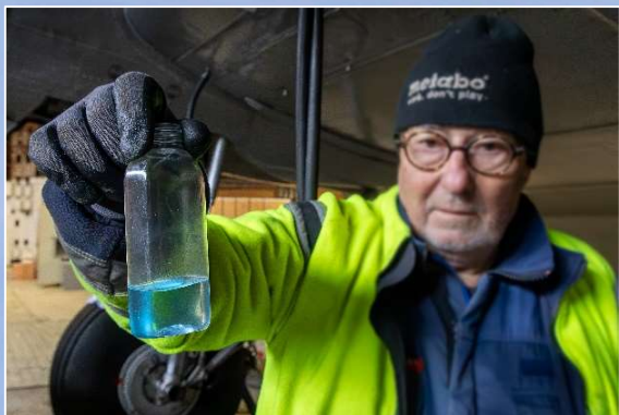
Brændstoftankene efterses og kontrolleres for kondensvand. Her er kun rent brændstof.
