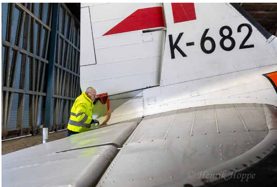
Søren Rasmussen sikrer sideroret efter kontrol af wireforbindelsen.
