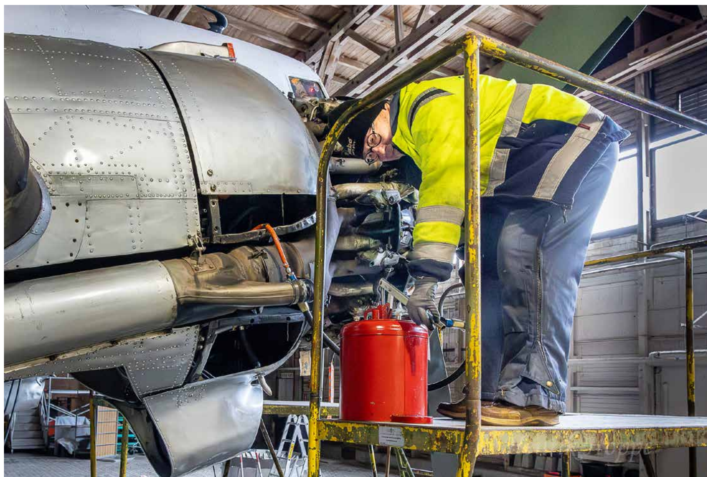
Sven Strøm pumper ny frisk olie i motoren.
