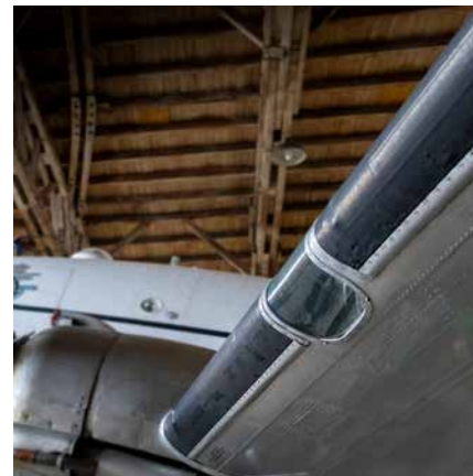
De-icing gummibander på flyets vinger og haleplaner bliver fjernet. De anvendes ikke mere og det vil reducere vægt.
