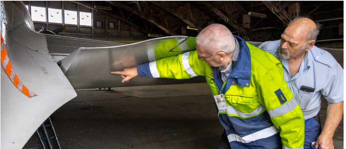
Også højderoret er ramt af en mindre strukturskade, der skal udbedres.
